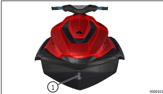
Figure 28 – Crochet avant de remorquage
