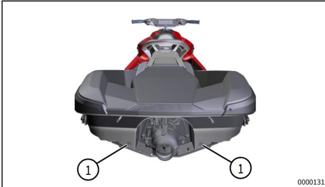
Figure 46 – Bouchons de vidange de cale
