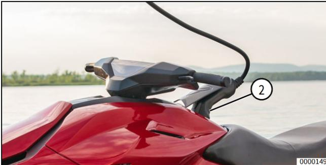
Figure 42 – Prise du câble de recharge
